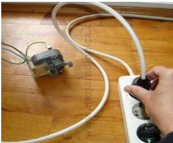
Повежите га на контакте мотора и пустите под напон. Уколико се мотор лагано окреће проблем је био у биксни коју сте подмазали. Уколико то није случај онда је проблем у лежајевима мотора или у самим намотајима. Прегоријевање намотаја једнофазног асинхроног мотора је ипак ријеткост. Проверава се тако што се дигиталним унимјером мјери отпорност која мора бити коначне вриједности. Уколико сте констатовали да је и то у реду поправка ће се сводити на подмазивање лежајева мотора.
