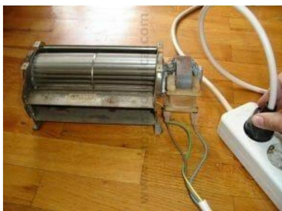
На крају склопите све обрнутим редом и прикључите на пробни кабл. Вентилатор се мора лагано окретати без запињања. И тиме сте извршили поправку вентилатора за ТА пећ.
