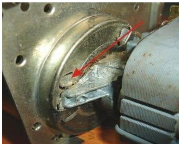
Користећи клијешта или шрафцигер исправите парче лима које не дозвољава демонтирање мотора са кућишта вентилатора ТА пећи.
