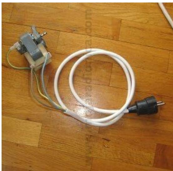
Да се вратимо на провјеру исправности мотора. Ту ће вам бити од користи пробни кабл. При овом испитивању треба нарочито бити опрезан. Не додиривати мотор када је пуштен под напон.
