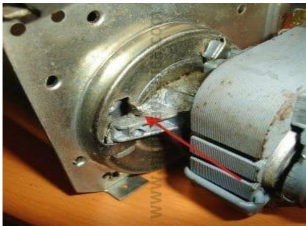
Да би сте очистили турбину од прашине, а и погледали да ли је можда проблем у мотору, он мора да се демонтира. Прије тога мора да се исправи осигурач који не дозвољава скидање мотора.
